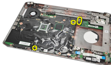
28. הרום את השוליים השמאליים של לוח המערכת כדי לשחרר אותו ממחברי היציאה ולאחר מכן הסר את לוח המערכת.
